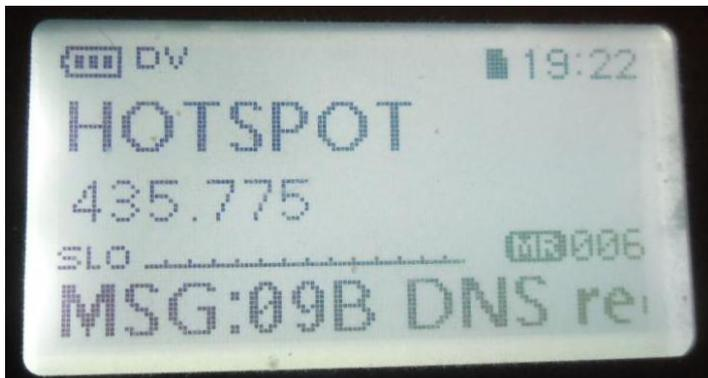
MSG: DCS009B DNS request (er versucht sich also zu DCS009B zu verbinden).
